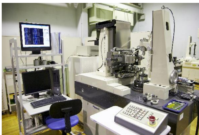
図 4. DAT-1 型 歯車基準機
