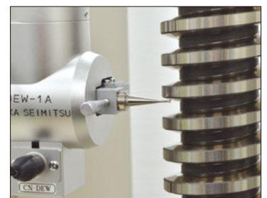
☀ ウォームの測定 Measurement of worm
