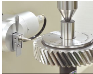
☀ 自動測定用マスターの測定 Measurement of master gear for automatic measurement
